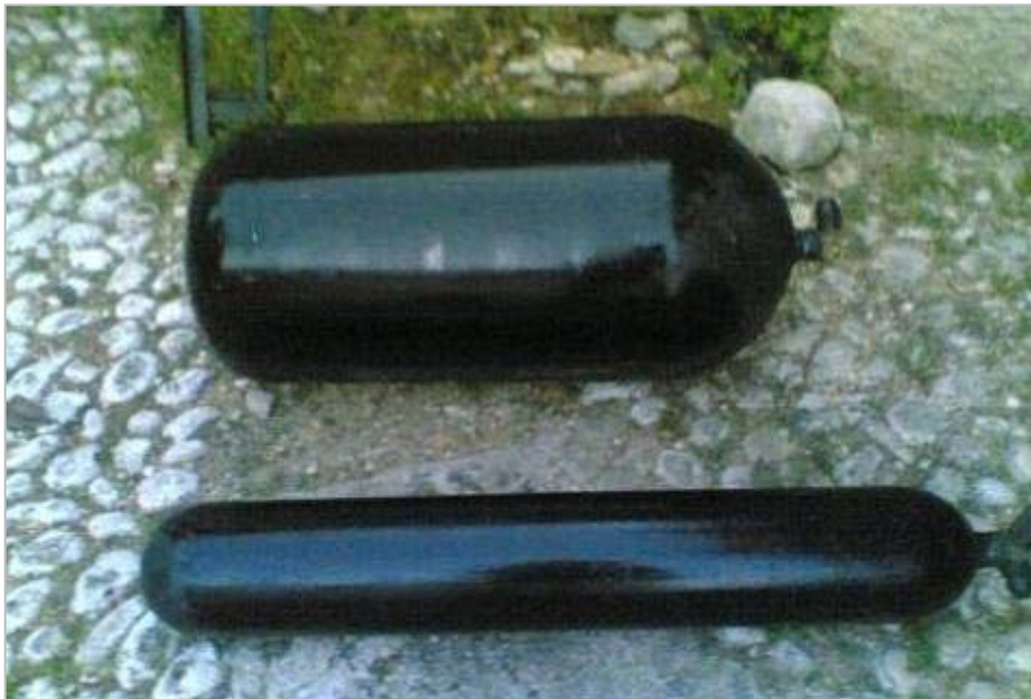
Serbatoi di metano compresso
