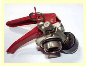
N.B. In caso di malfunzionamento della valvola, lo scoppio del serbatoio è evitato grazie alla filettatura che rappresenta un "punto debole" costruttivo: in questi casi il blocco leve viene sbalzato via dal serbatoio
